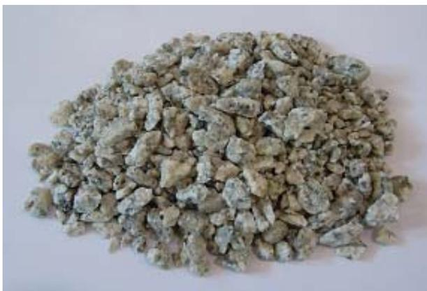
**Fig. 1 - Aggregato grosso di granito**
