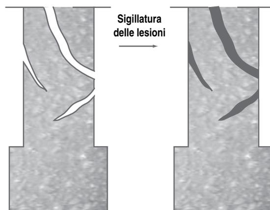
**Fig. 14 - Sigillatura di lesioni superficiali mediante iniezione di liquidi monomerici che successivamente solidificano per polimerizzazione**
