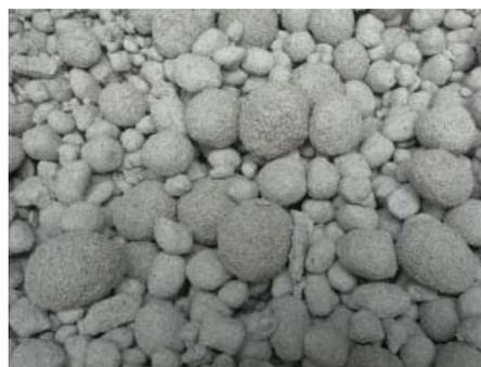
**Fig. 4 - Miscela M6: dopo aver aggiunto ai componenti secchi  $150 \text{ kg/m}^3$  d'acqua e l'intero additivo (1,7 %) la miscela si raggruma in granuli di dimensioni variabili da pochi millimetri a 5 cm, rivestiti esternamente di particelle fini non idratate.**
