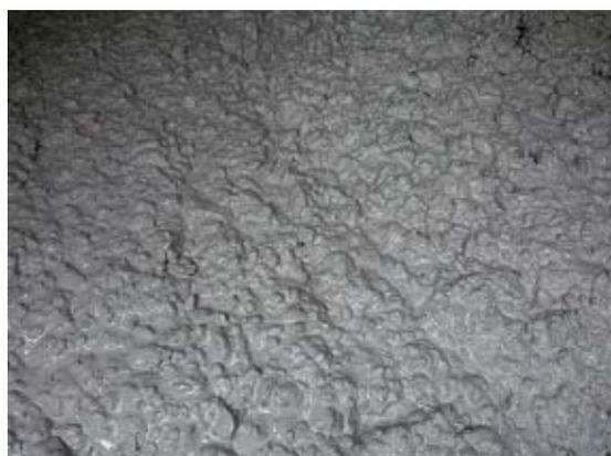
**Fig. 7 - Miscela M6: dopo due arresti nell'azione della betoniera per far aderire i granuli e facilitarne la rottura, un ultimo mescolamento della durata di dieci minuti consente di ottenere un impasto omogeneo.**
