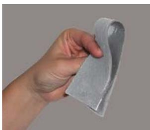
**Fig. 17 - Malta cementizia a spessore millimetrico resa flessibile dalla presenza di poliacrilato**
