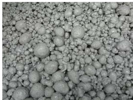
**Fig. 5 - Miscela M6: aggiunta la parte restante d'acqua ( $3 \text{ kg/m}^3$ ) i granuli in cui il calcestruzzo è raggrumato appaiono bagnati in superficie, e cominciano ad aderire l'un l'altro.**
