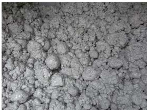
**Fig. 6 - Miscela M6: le fasi di arresto della betoniera favoriscono l'adesione dei granuli l'uno all'altro e ne facilitano quindi la rottura nelle successive fasi di azione.**
