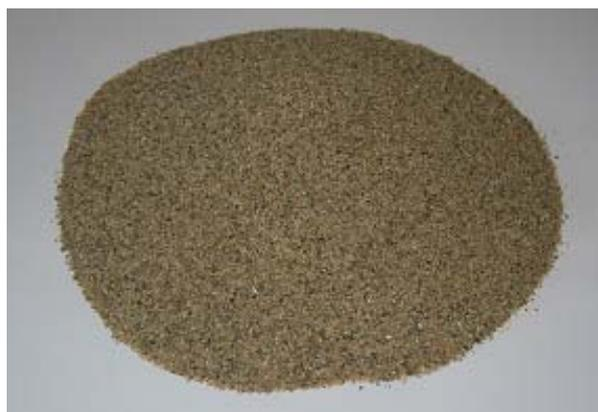
**Fig. 3 - Sabbia monogranulare puramente silicea**
