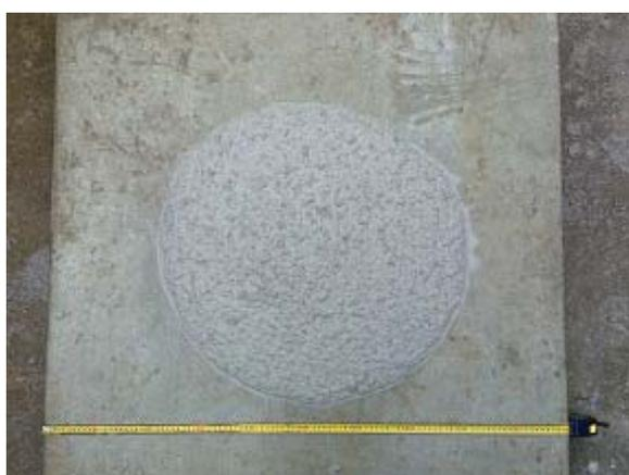
**Fig. 8 - Prova di abbassamento con il cono di Abrams della miscela M6: lo spandimento è risultato pari a 60 cm e la miscela non ha mostrato alcuna tendenza alla segregazione.**
