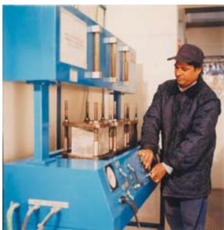
Fig. 4 - Apparecchiatura della prova di permeabilità secondo ISO 7031.
