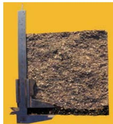
Fig. 5 - Misura dello spessore di acqua penetrata (ISO 7031) in un provino di calcestruzzo sottoposto alla pressione di 5 atm per 3 giorni.
