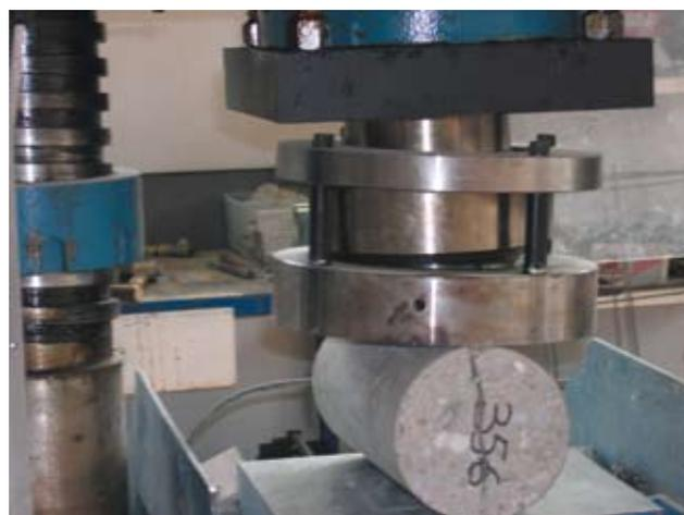
Fig. 9 - Rottura di un provino cilindrico di calcestruzzo per determinare la resistenza con il metodo detto “alla brasiliana”.
