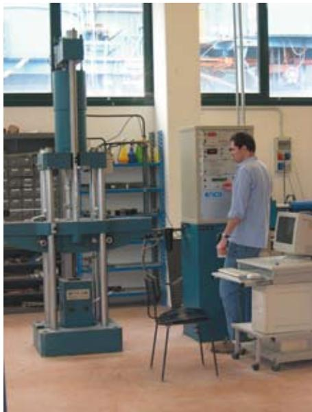
Fig. 7 - Prova di trazione  $\sigma$ - $\epsilon$  su una barra di acciaio.
