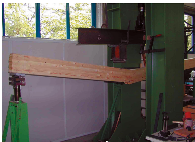
Fig. 3 - Comportamento tipico della trave in legno lamellare armata inflessa in fase di collasso
