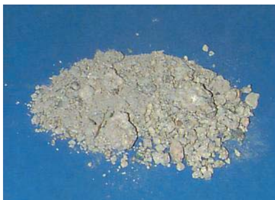
Fig. 1 - Cenere pesante proveniente dall'inceneritore di Vercelli prima del processo di vetrificazione
