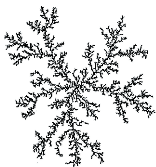
Fig. 3 - Struttura delle particelle ottenute da un sol polimerico in cui si formano strutture debolmente ramificate
