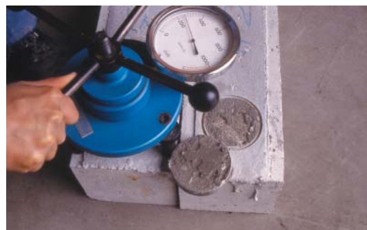
Fig. 6 - Prova di strappo per la determinazione della tensione di aderenza residua
