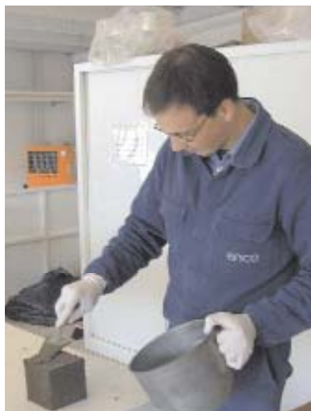
Fig. 1 - Realizzazione dei provini rivestiti da destinare alle prove di penetrazione accelerata
