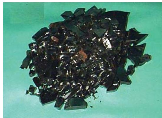
Fig. 2 - Vetro ottenuto dalla vetrificazione delle ceneri pesanti provenienti dall'inceneritore di Vercelli
