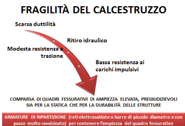
Fig. 1 – Le intrinseche debolezze del calcestruzzo
