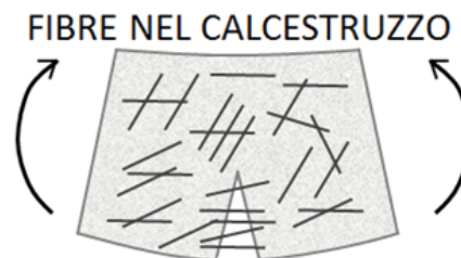
EFFETTO DI CUCITURA DELLE FESSURE ESERCITATO DAL RINFORZO FIBROSO
