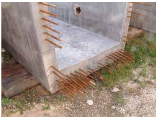
Fig. 2 – La faccia posteriore di un prototipo: le cavillature sono localizzate nella parte verticale nella posizione indicata
