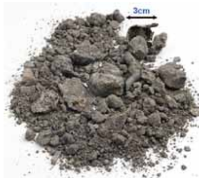
Fig. 1 - Ceneri pesanti da RSU raccolte nella griglia del termovalorizzatore.
