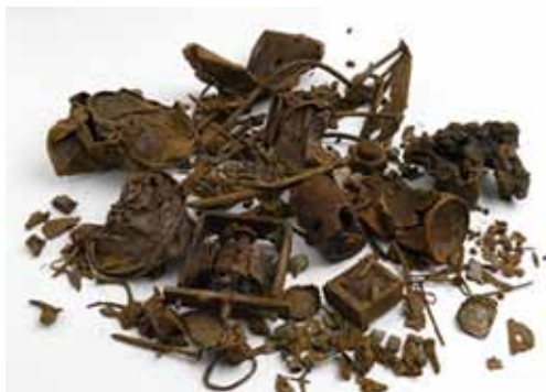
Fig. 2 - Residui metallici ferrosi separati dalla cenere pesante.
