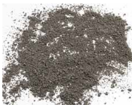
Fig. 3 - Cenere pesante dopo la rimozione delle parti metalliche.
