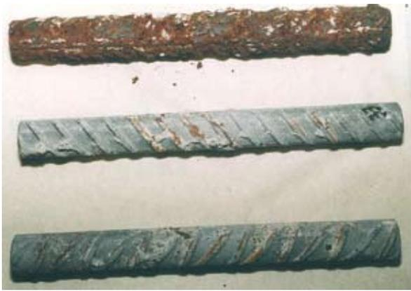
**Fig. 6 – Tondini rimossi da cilindri di calcestruzzo prodotti con 3.2 % NaCl (cloruro di sodio) dopo esposizione di 3 anni a 38°C e 90% RH (umidità relativa). Il tondino in alto è il campione di riferimento, in mezzo quello da calcestruzzo con + 2 % CN, in basso il tondino da calcestruzzo con + 4% CN.**
