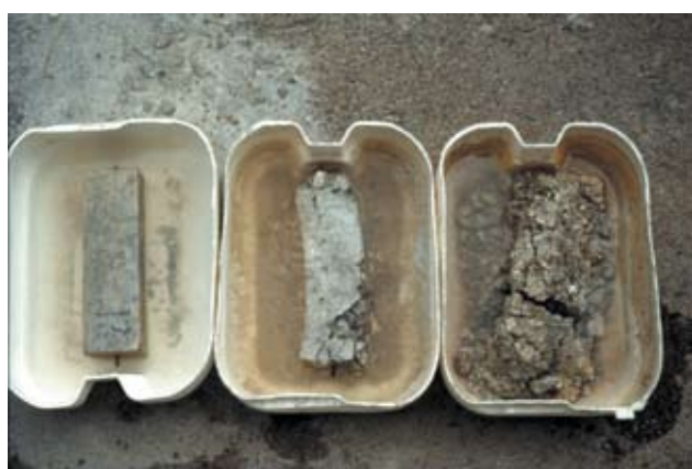
Fig. 3 - Distruzione progressiva (da sinistra a destra) di un provino di conglomerato cementizio immerso in un ambiente solfatico: nel centro il provino si è deformato e fessurato per formazione di ettringite; a destra il provino si è "disintegrato" per formazione di thaumasite.
