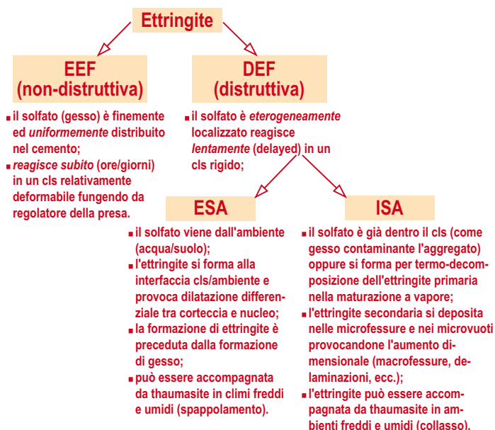
Fig. 1 - Schematizzazione dei processi di formazione dell'ettringite: non-distruttiva ed utile per la regolazione della presa (EEF); distruttiva e dannosa per il dissesto delle strutture in calcestruzzo (DEF).
