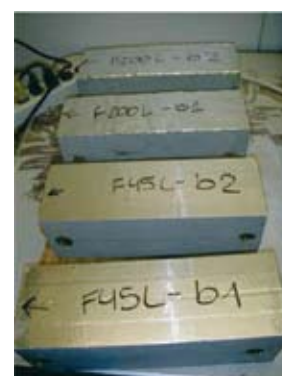
Fig. 4 - Provini lineari ricoperti con pellicola adesiva di alluminio.
