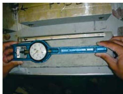
Fig. 3 - Metodo di misurazione del ritiro libero.
