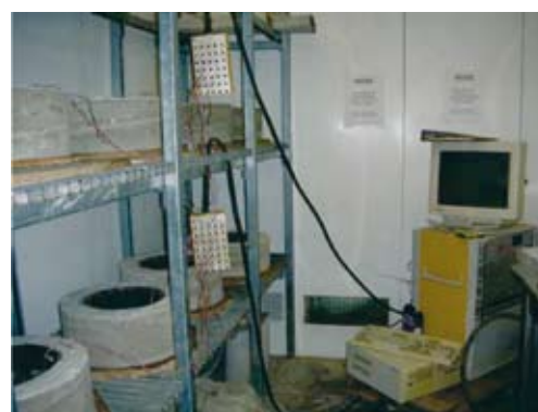
Fig. 2 - Esposizione dei provini in camera climatica.
