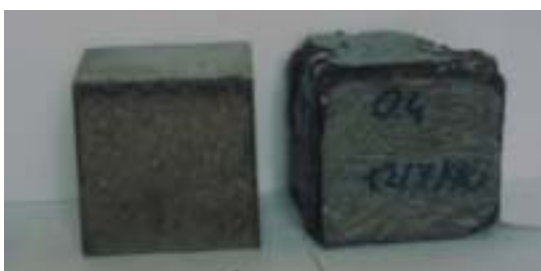
Fig. 7 – Provino di calcestruzzo non armato prima e dopo il degrado provocato dal CaCl_2
