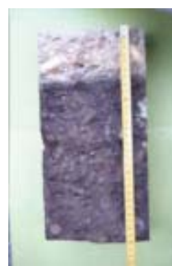
Fig. 6 – Sezione di una struttura penetrata dal cloruro (zona chiara)
