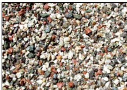
Fig. 2 - Frazione fine (0-5 mm) e frazione grossa (5-15 mm) di aggregato riciclato da macerie di demolizione.
