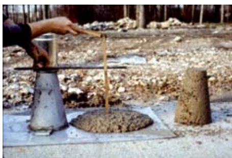
Fig. 5 - Calcestruzzo con rapporto a/c = 0.45 in assenza (a destra) ed in presenza di additivo superfluidificante.
