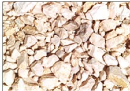
Fig.1 - Sabbia naturale (0-5 mm) e frantumato naturale (5-15 mm).
