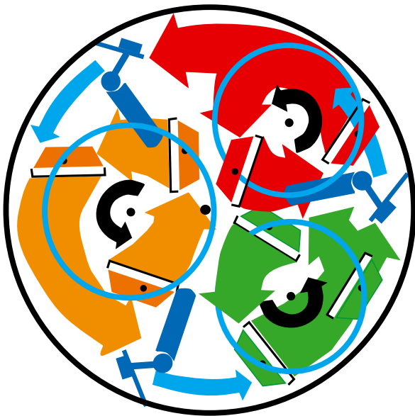
Fig. 6 - Rappresentazione schematica del mescolatore controcorrente con 3 pale rotanti che girano nel senso opposto al movimento del contenitore.
