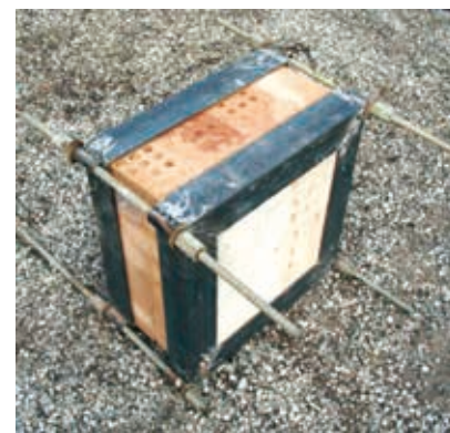
Fig. 1 - Preparazione del provino di muratura per il trasporto in laboratorio
