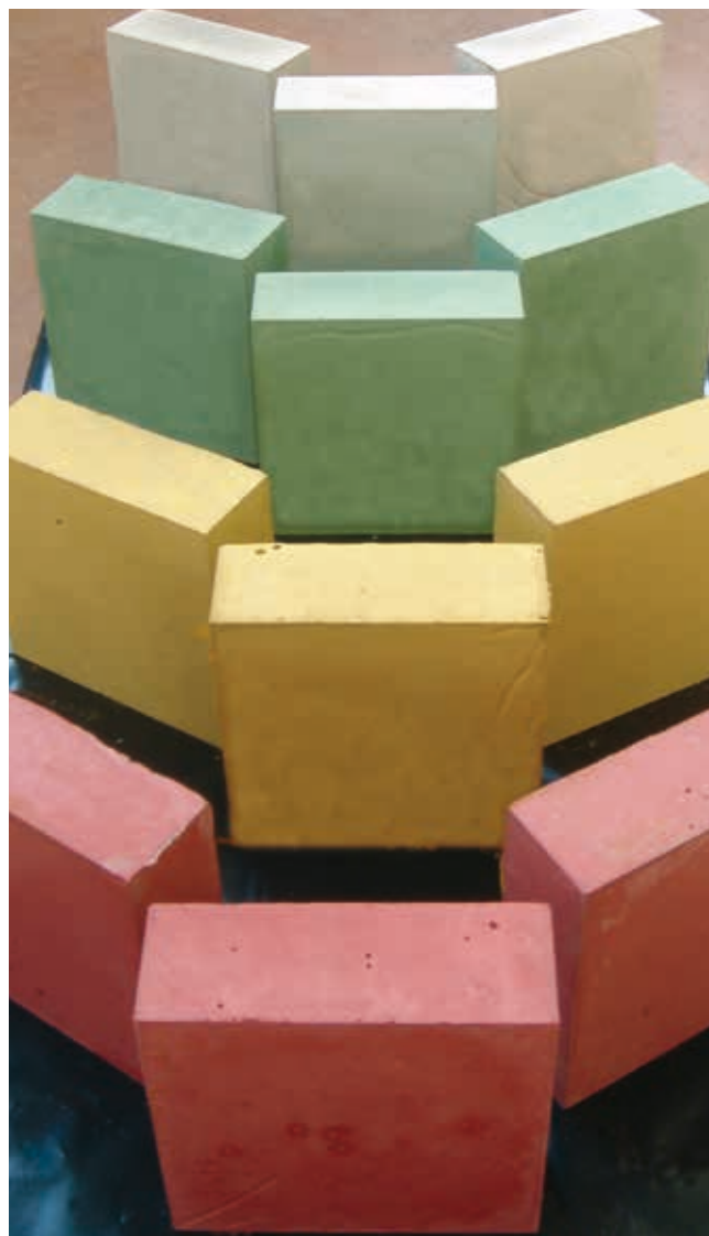
Fig. 1 - Provini di calcestruzzo bianco con aggiunte di pigmenti
