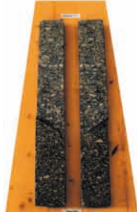
Fig. 2 - Assenza di segregazione di una carota (>1m) in un getto di SCC.
