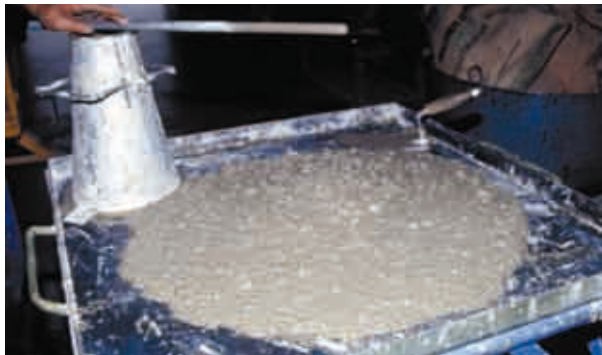
Fig. 4 – Calcestruzzo autocompattante nella prova dello slump flow.
