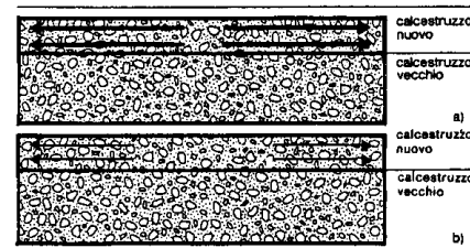
1 L'espansione contrastata nel calcestruzzo provoca uno stato di compressione (a) che diminuisce a causa del successivo ritiro (b). Le frecce dentro il calcestruzzo rappresentano la compressione.
