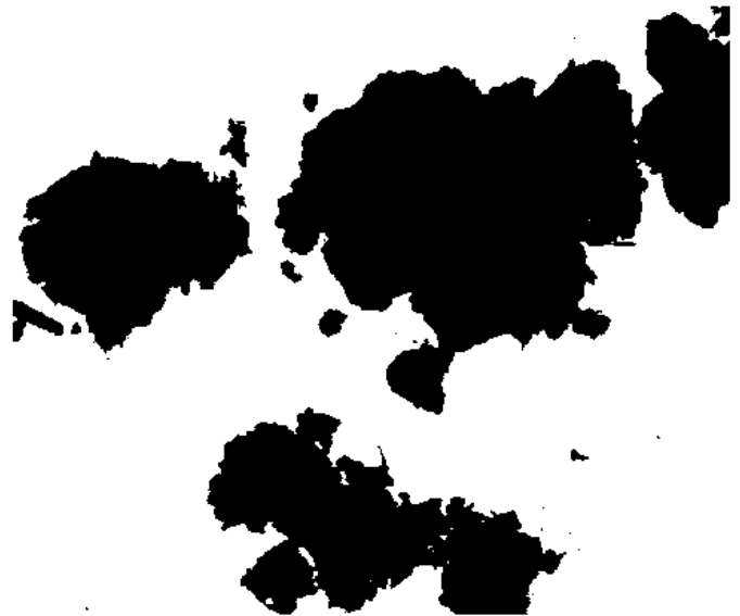
10 - Microfotografia del cemento Portland n° 3 contenente \text{CaCl}_2 ( \times 40.000 ).
